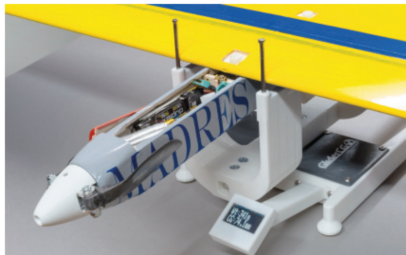
Der MAD-RES von Zeller Modellbau hat eine Flächentiefe von nur 170 mm. Zum Positionswechsel des Akkus muss das Modell nicht von der digitalen Waage genommen werden.
